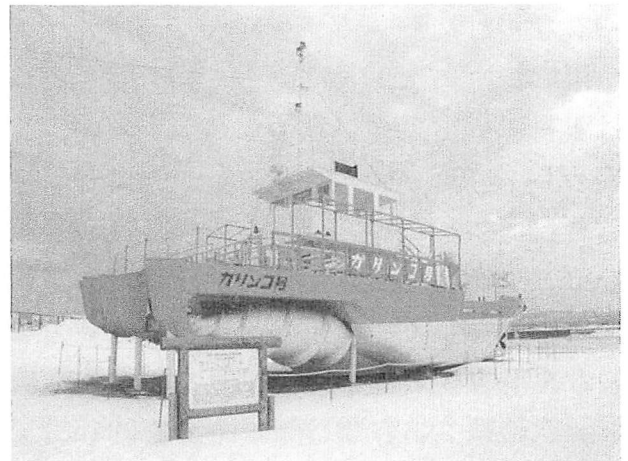
紋別のガリンコステーションに隣接する公園に保存している「ガリンコ号」。船首のアルキメディアン・スクリューの形状がよくわかる。
